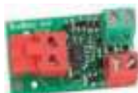
XIB интерфейс для релейных фотоэлементов (для плат E045S или E024S)
