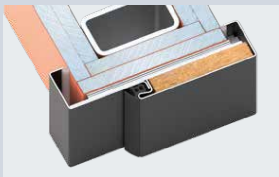
3. Через канавку для уплотнения соединить винтами профиль доборной коробки с профилем и затем вставить поверх данного соединения уплотнение двери
